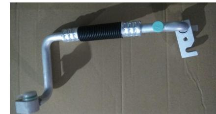
图 1-2 汽车空调套管
