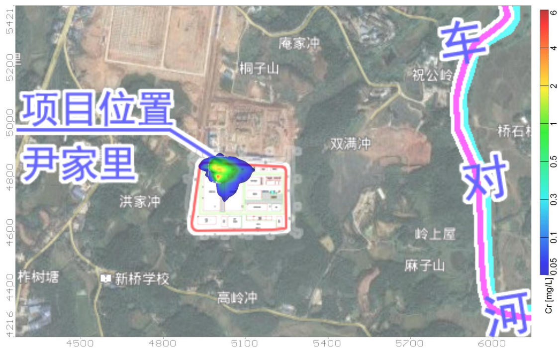
图 5.6-26 项目非正常工况渗漏 1000 天后 Cr 污染物影响范围图
