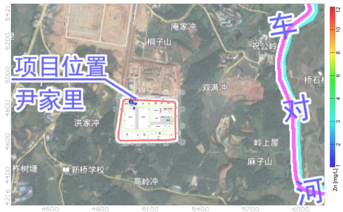
图 5.6-22 项目非正常工况渗漏 100 天后 Zn 污染物影响范围图
