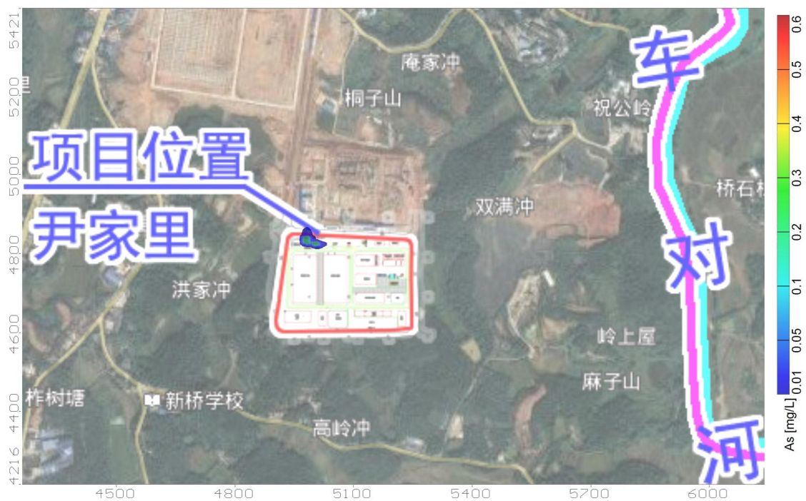
图 5.6-28 项目非正常工况渗漏 100 天后 As 污染物影响范围图
