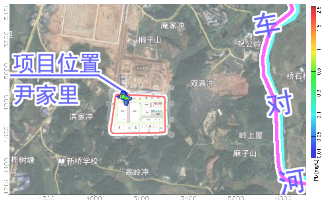
图 5.6-19 项目非正常工况渗漏 100 天后 Pb 污染物影响范围图
