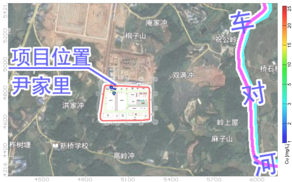
图 5.6-13 项目非正常工况渗漏 100 天后 Cu 污染物影响范围图
