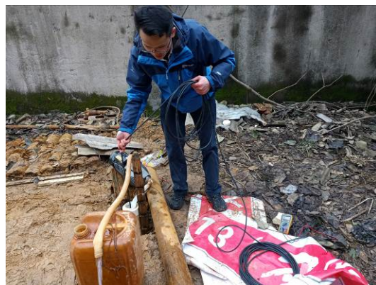
图 5.1.2.3-4 DX04 钻孔水位测量照片
