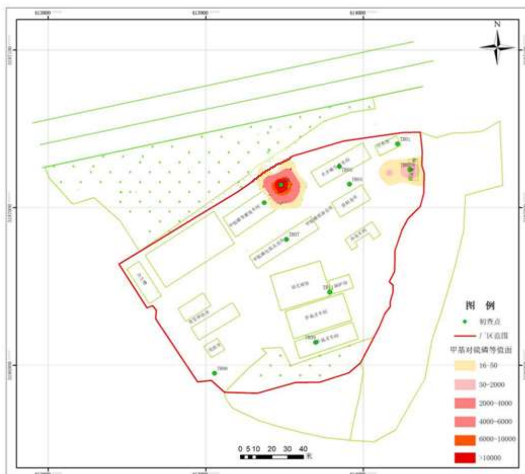
图 4.1.2-3 农药厂粉质粘土层（0-2m）甲基对硫磷污染范围和程度
