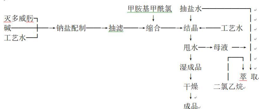
图 3.2.3.3-1 灭多威原药工艺流程图
