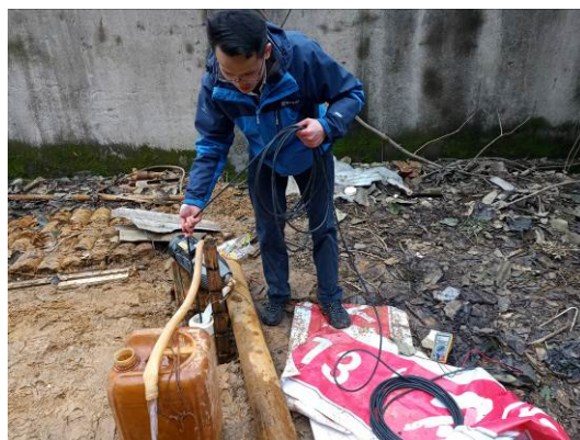
图 5.1.2.4-2 抽水试验（自吸泵）
