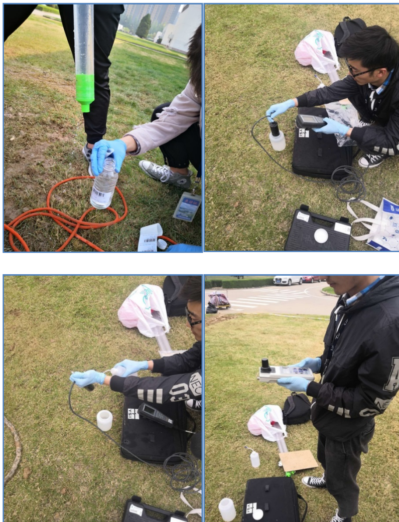
图 4.3.2.3-2 采样前洗井参数测试
