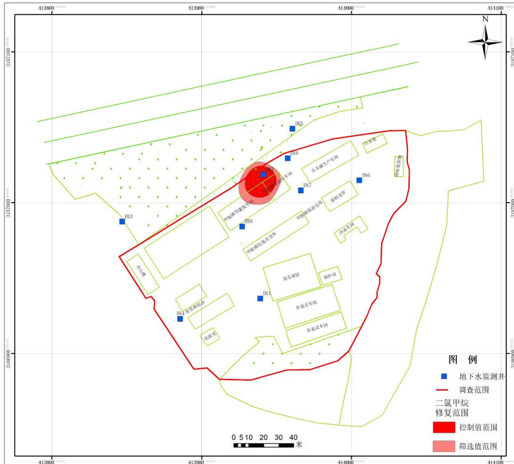
图 7.2.2-1 地下水二氯甲烷修复范围（以控制值范围为修复范围）
