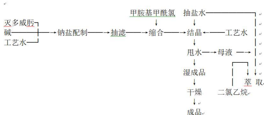
图 3.1.3-1 灭多威原药工艺流程图
