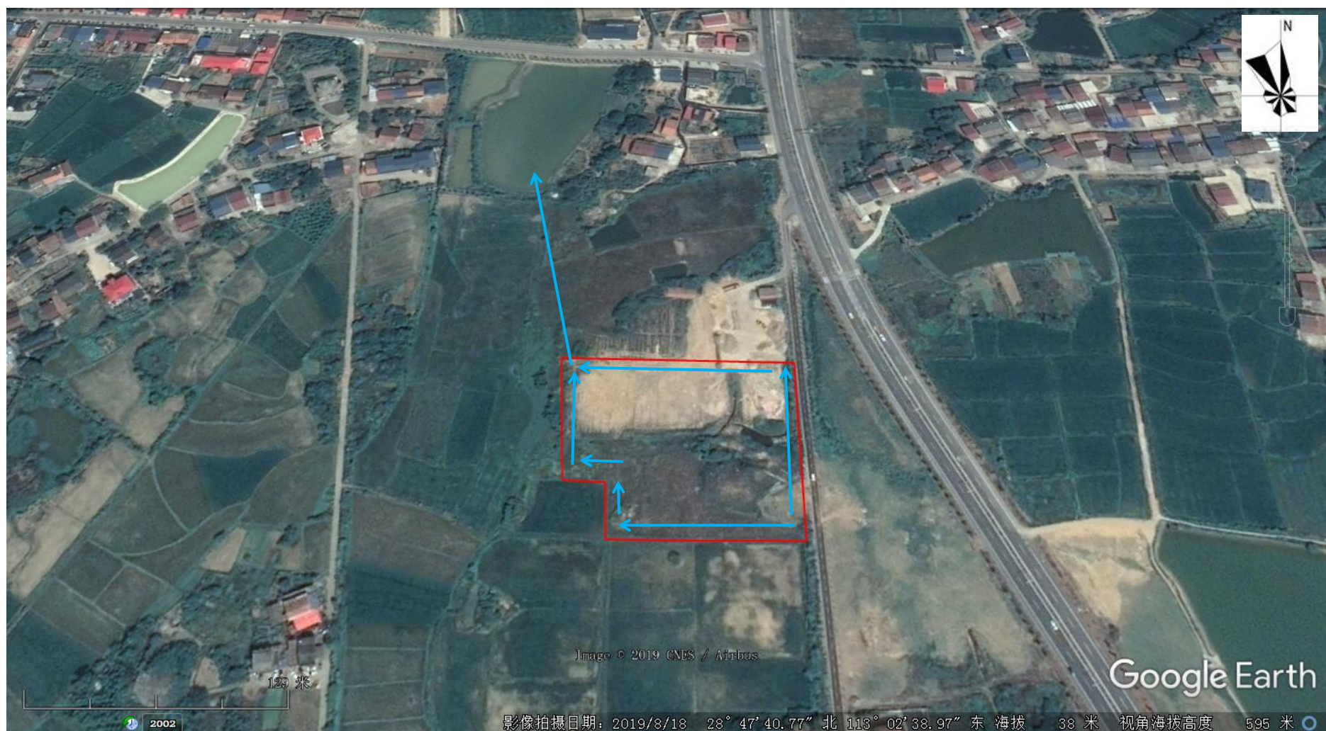
附图五 后期雨水排水路线图
