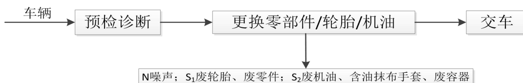
图 2-6 营运期汽车维修服务工艺流程及排污节点图
