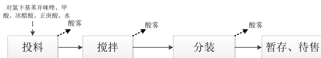
图 2-2 抗氧化清洁剂工艺流程及产污节点图
