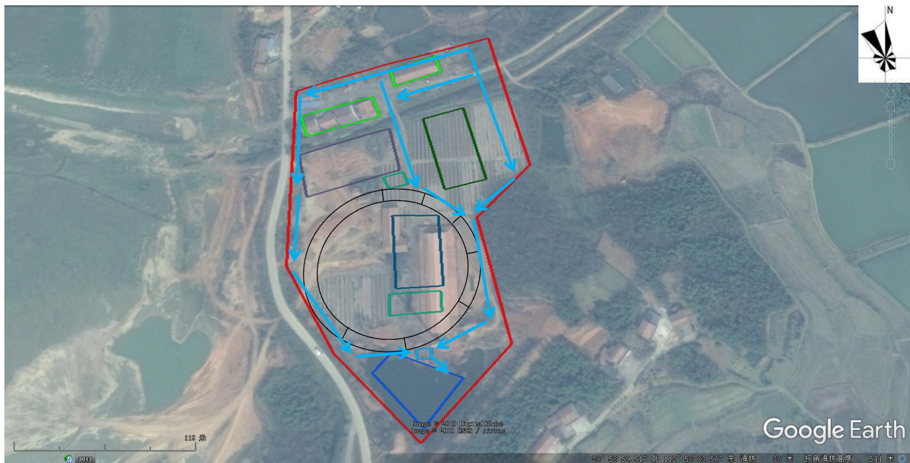
附图 6：雨水排水路线图
