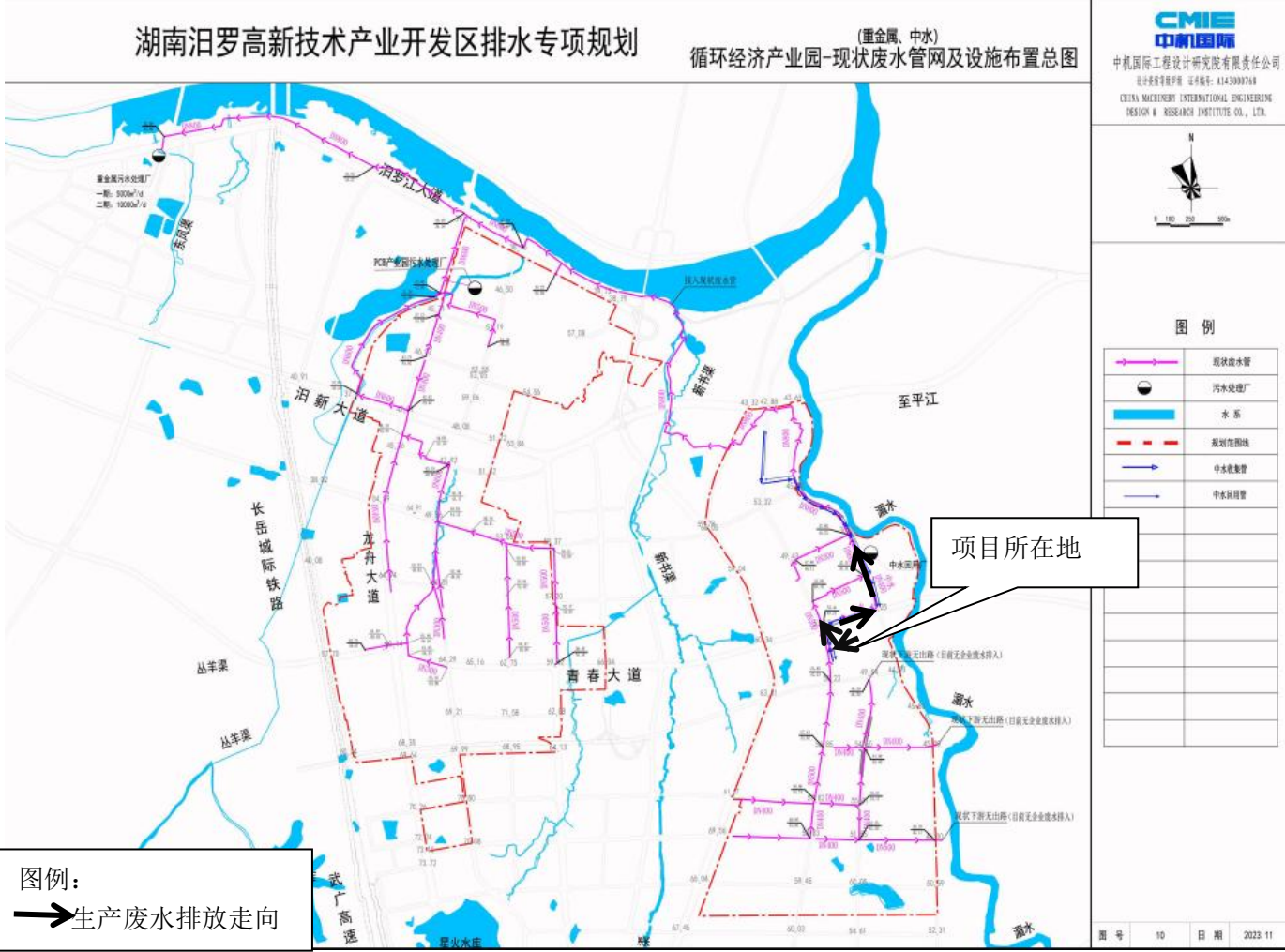
附图 6 生产废水排水走向图
